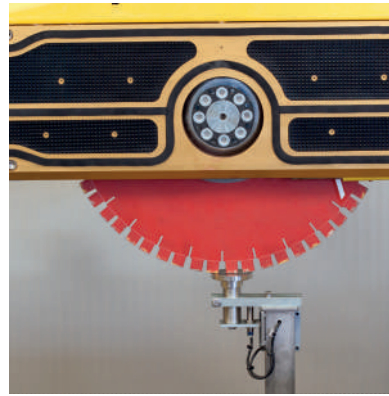
CODE 编号: A5501 TOOL DIAMETER CONTROL 刀具直径/长度测量器
