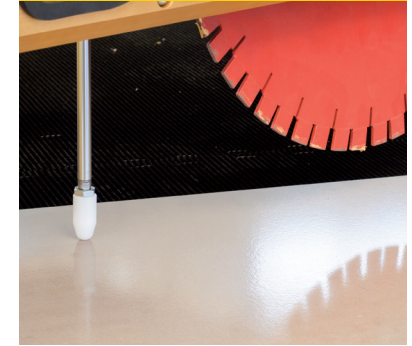
SLAB THICKNESS READER 大板厚度检测仪
